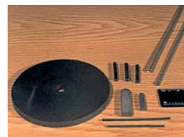
Катоды-мишени для магнетронного распыления и электроды для электроискрового упрочнения марки СВС
