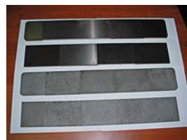
Катоды-мишени для магнетронного распыления и электроды для электроискрового упрочнения марки СВС
