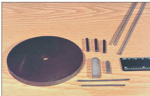
Стержневые и дисковые электроды для ЭИЛ и ТРЭУ
