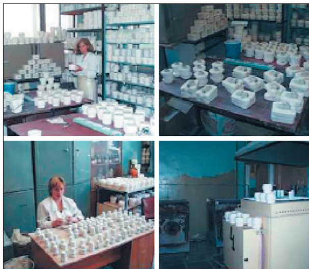
Производство керамических тиглей для получения сплавов медицинского назначения методом литья
