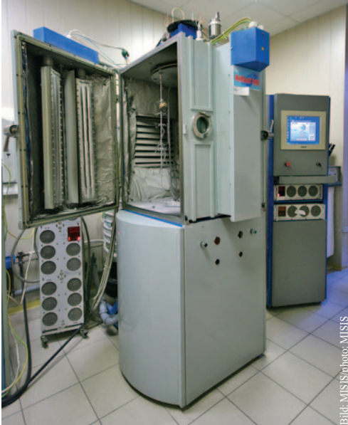
Abb. 7: Anlage zum gepulsten Zweikathoden-Sputtern „Unicoat 900“ mit 4 planaren Magnetrons und Ionenquelle Fig. 7: Complex for pulsed dual cathode magnetron sputtering “Unicoat 900” with 4 planar magnetrons and ion source
