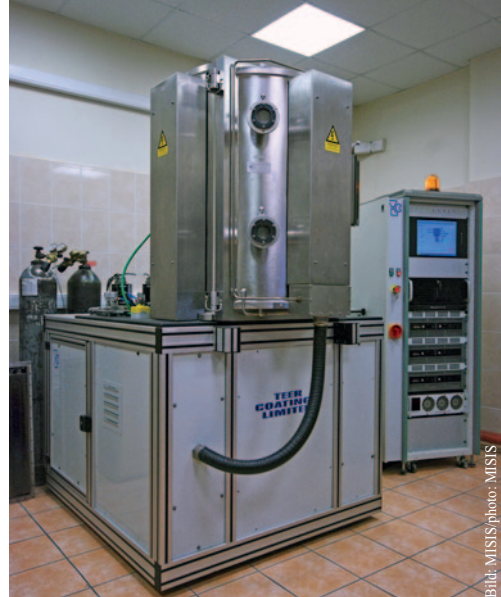
Abb. 8: Anlage zum Magnetronsputtern UDP850/4 (Teer, UK) mit 4 planaren Magnetrons Fig. 8: Complex for magnetron sputtering UDP850/4 (Teer, UK) with 4 planar magnetrons
